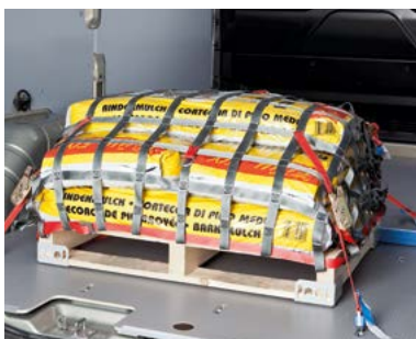
Gecombineerde last die net en dwarsbalken vastzet
